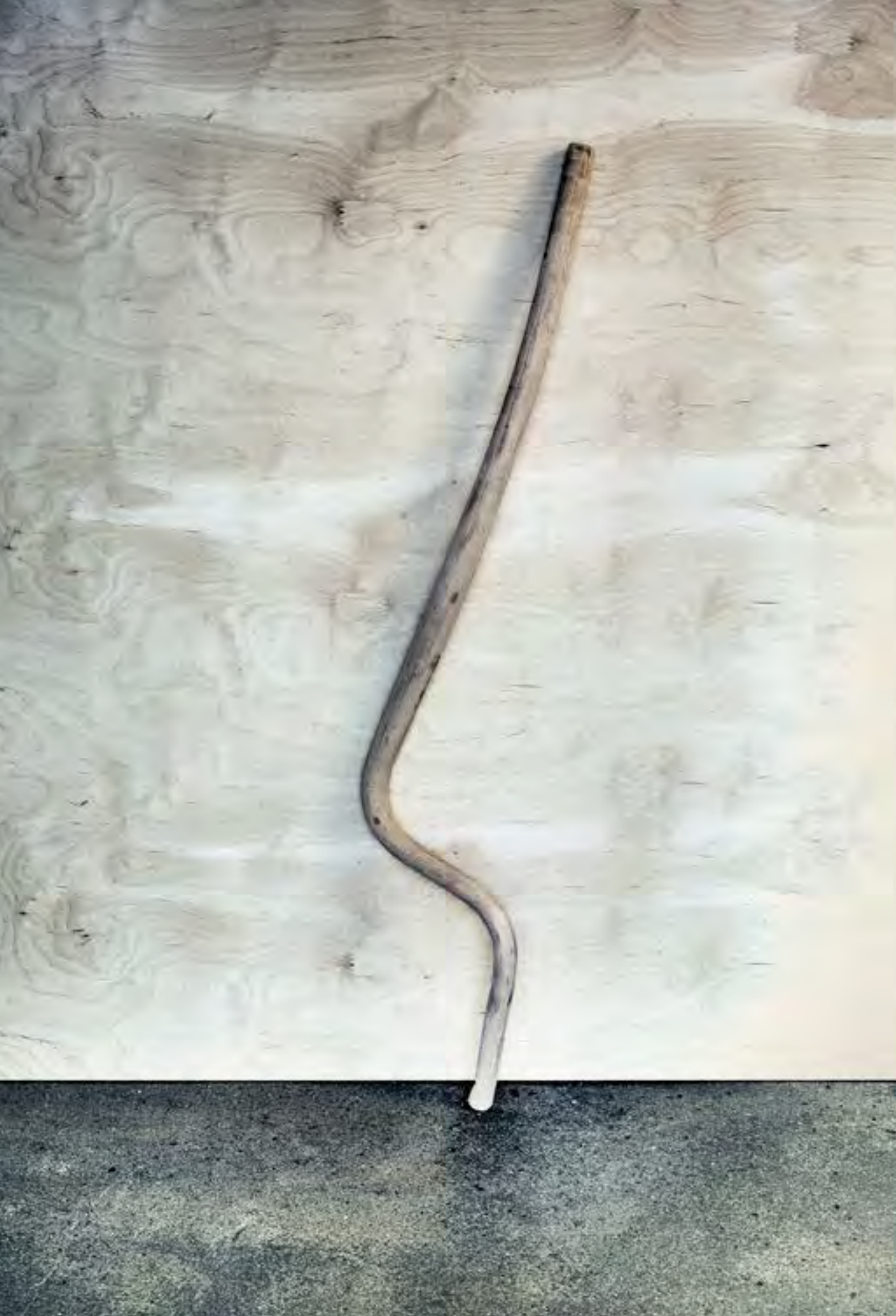
cz Neopracovaný ohýb přední nohy dětské křesíčky Petit en Crude bend of Petit children's chair's front leg de Unbearbeitete Biegung des vorderen Fußes beim Kinderstuhl Petit pl Surowy element nogi przedniej fotela do karmienia dzieci Petit
